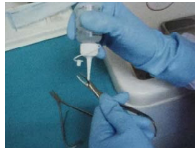
การหยอดน้ำมันหล่อลื่นบริเวณข้อต่อของเครื่องมือ
