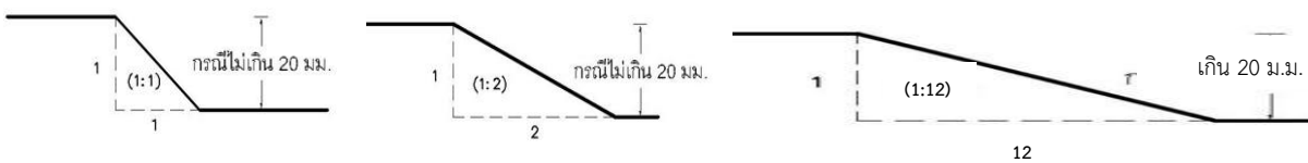
รูปที่ 3 ตัวอย่างการปาดมุมลาดเอียง สำหรับพื้นต่างระดับ
