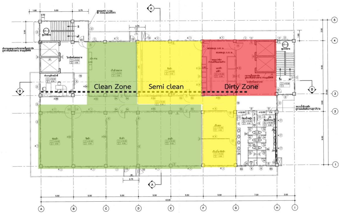
รูปที่ 1 ตัวอย่างผังแผนกซักฟอกที่มีการแบ่งเขต/โซน (แบบอาคารสนับสนุนบริการ 5 ชั้น แบบเลขที่ 10153)
