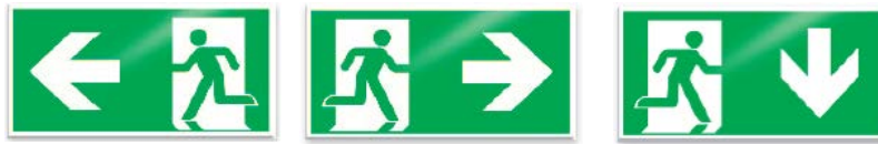
รูปที่ 4 แบบสัญลักษณ์ทางออกฉุกเฉินมีขนาด 150 x 300 mm
